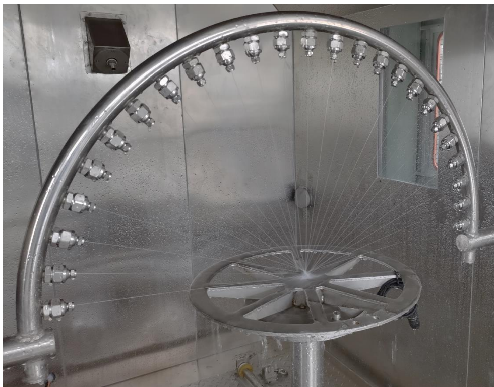
IPX3/X4: \Phi 0.4 孔径, R400 摆动管
